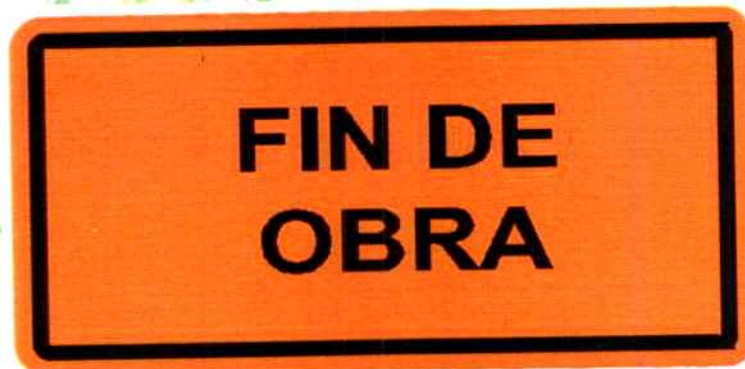
Ilustración 3 - SIO-02 Fin de obra
